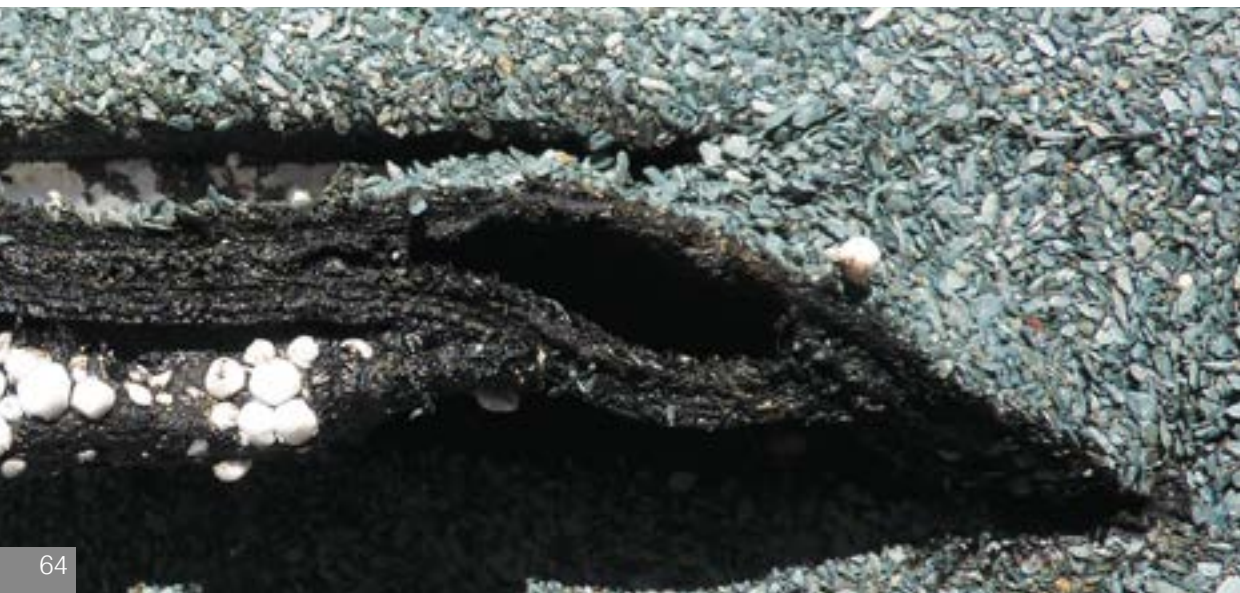
151 Systémovo nezvarený kanálik medzi starým pásom a pásom Poly-Elast Rapid O.
