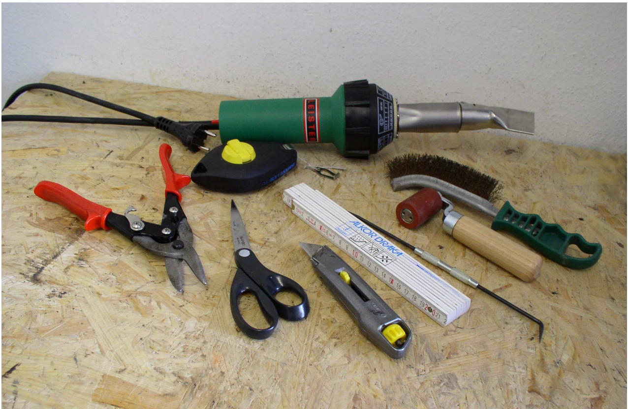
Foto 2. Nástroje pre montáž fóliových systémov.
